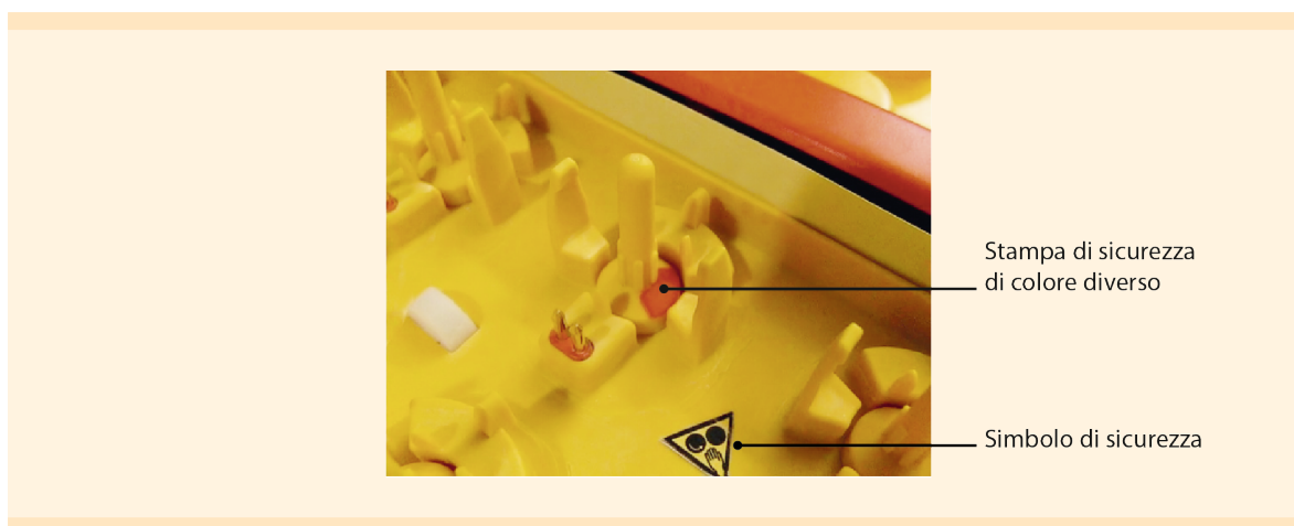
Figure 1: Simbolo di sicurezza sul fondo della vaschetta del gentleMACS Octo Dissociator with Heaters.
